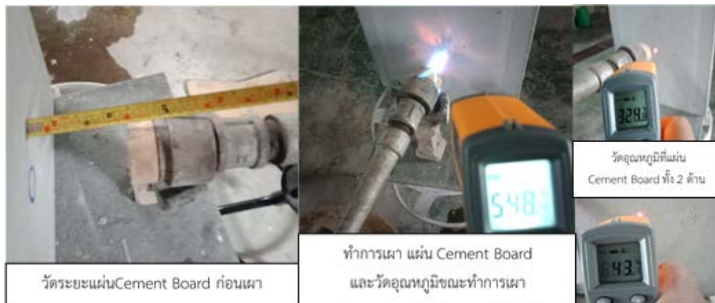
รูปที่ 3 แสดงการเตรียมชิ้นทดสอบเพื่อทดสอบการทนความร้อนที่เกิน 500 °c - 1000 °c
