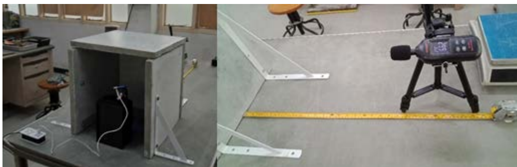
รูปที่ 2 แสดงการเตรียมชิ้นทดสอบเพื่อทดสอบการดูดซับเสียงของแผ่นซีเมนต์บอร์ด
